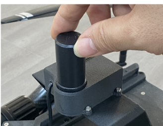
6:安装RTK天线
